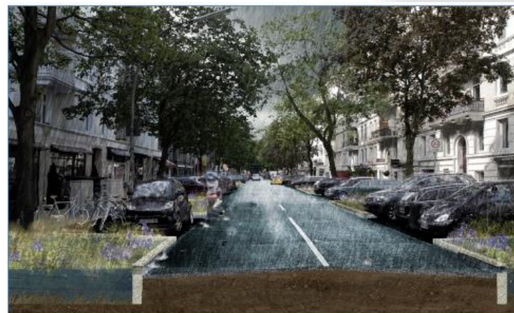
Abb. 48: Beispiellösung A - Entwässerung über Tiefbeete
